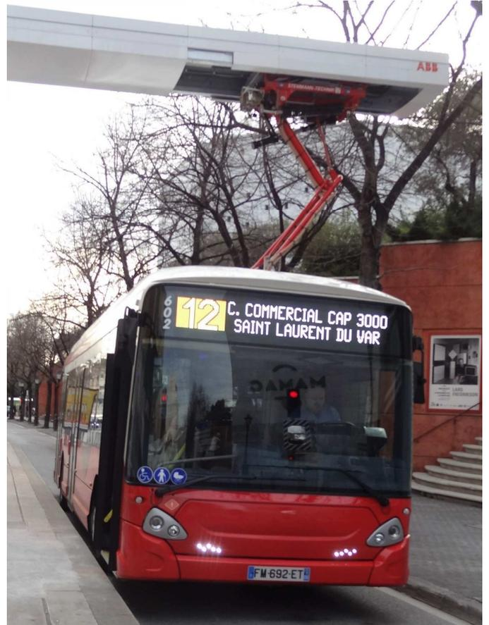
▲ Le GX337Elec n° 602 de la ligne 12 recharge ses batteries au terminus de la ligne 12 Promenade des Arts. On peut distinguer le pantographe rouge ascendant qui capte le courant sur la borne blanche de marque ABB.
