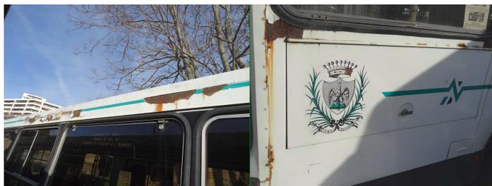
▲ Repeint pour la dernière fois en 1999, notre "273" présente de nombreuses surfaces profondément rouillées avec le temps et du fait qu'il est stationné aux intempéries au dépôt RLA de Drap.
