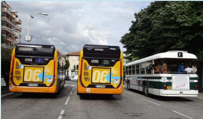
▲ Le contraste est saisissant : les deux modernes Urbanway à gauche (gasoil) et au centre (GNV) abritent moteur et boîte-à-vitesses dans un compartiment arrière jusqu'à plus de 3 m. du sol alors qu'avec son moteur avant, notre 205 propose un balcon aéré sur la ville ! Lequel préférez-vous ?
