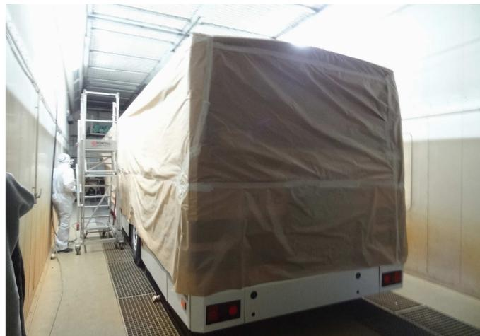
Désormais, grâce à l'implication bénévole de notre ami Lionel Martini, nous allons pouvoir lancer la rénovation extérieure d'autres véhicules de notre collection ! Le dépôt de Drap accepte de nous prêter sa cabine de peinture durant ces périodes-là. A nous de traiter les panneaux rouillés car les bas de caisse et éléments de pare-chocs seront peints, pièce par pièce, par les carrossiers de RLA.
